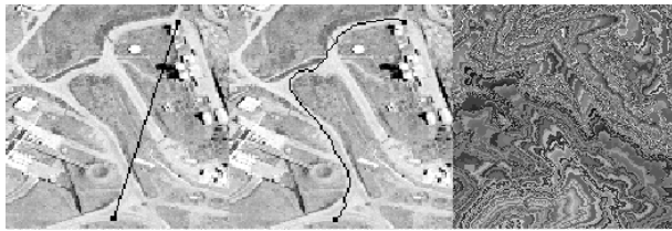
Figure 3: Minimum Global d'un contour actif par propagation de front. Le contour minimal entre les deux points donnés à gauche est trouvé sur l'image du centre. A droite on voit la fonction de coût à partir du point de départ. Remarquer la propagation plus rapide le long des routes.
